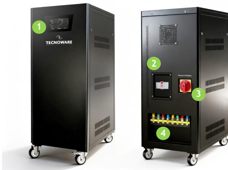
Figura 7 - Fronte e Retro FSTESM100KT2 - FSTESM120KT2 (1. Display Touch, 2. Interruttore Stabilizzatore, 3. Interruttore Bypass, 4. Pannello di accesso alla Morsettiera)
