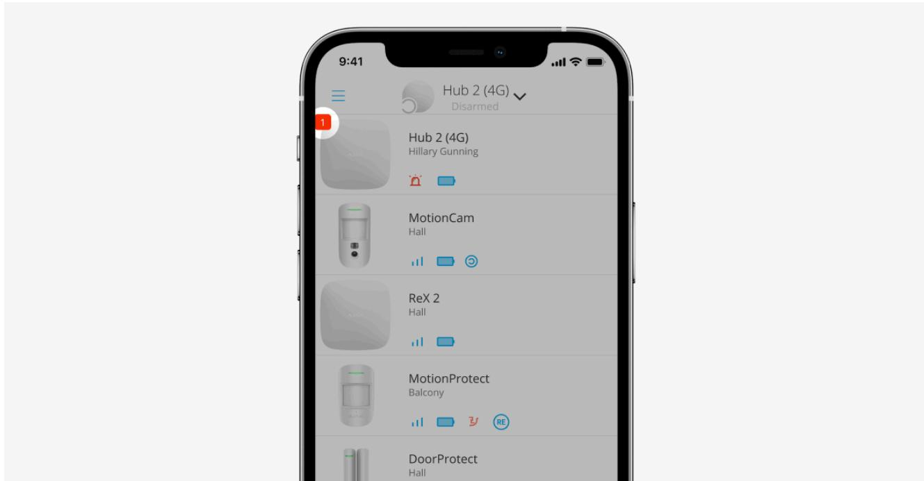
Se viene rilevato un guasto dell'hub (ad esempio, non è disponibile l'alimentazione esterna), viene visualizzato un contatore guasti sull'icona del dispositivo nell'app Ajax.
