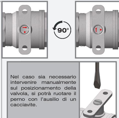
Nel caso sia necessario intervenire manualmente sul posizionamento della valvola, si potrà ruotare il perno con l'ausilio di un cacciavite.
