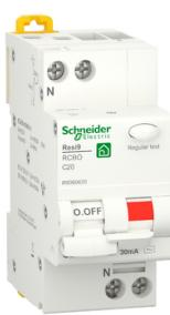
Interruttore magnetotermico differenziale (RCBO), Resi9, 1P+N, 20 A, curva C, 4500 A, tipo CA, 30 mA
