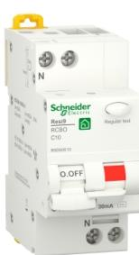
Interruttore magnetotermico differenziale (RCBO), Resi9, 1P+N, 10 A, curva C, 4500 A, tipo CA, 30 mA
