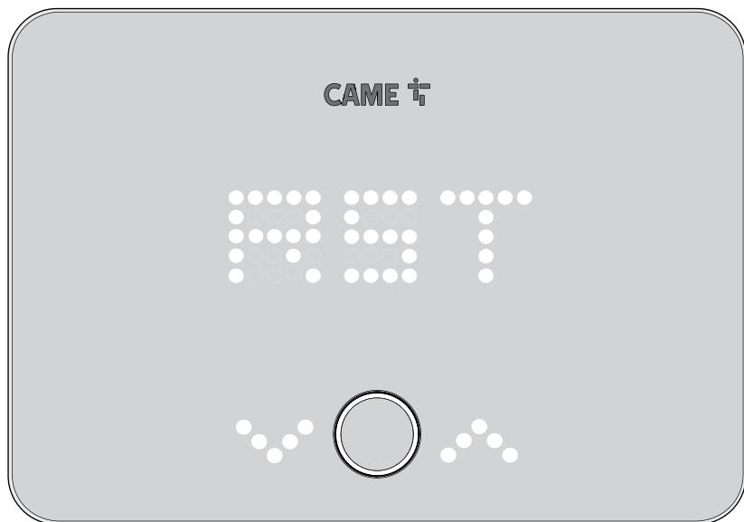
Sono possibili tre reset differenti: Reset della connessione radio al Border Router (NET), reset della parte termica del dispositivo (TH) e reset totale per il ripristino delle condizioni di fabbrica (ALL). Per uscire dal menu di reset utilizzare la freccia INDIETRO.
