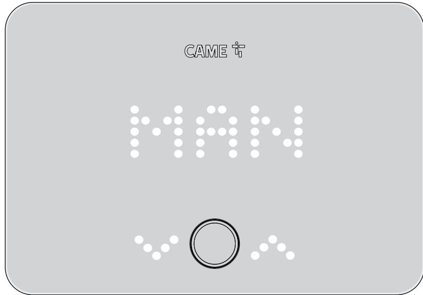
Da questa schermata, premendo il pulsante meccanico, è possibile visualizzare e modificare la temperatura che è stata impostata da APP come temperatura desiderata. Per modificare la temperatura desiderata, utilizzare le frecce ai lati del pulsante meccanico. La temperatura viene modificata di un decimo di grado ad ogni pressione di una delle due frecce.
