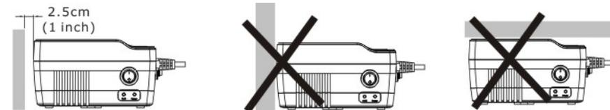
Non utilizzare l'unità in ambienti in cui temperature e umidità eccedano i limiti previsti dalle specifiche tecniche (vedi). Tenere l'unità pulita dall'accumulo di polvere. Evitare vibrazioni meccaniche, la vicinanza a gas infiammabili e a esplosivi e/o agenti corrosivi.
