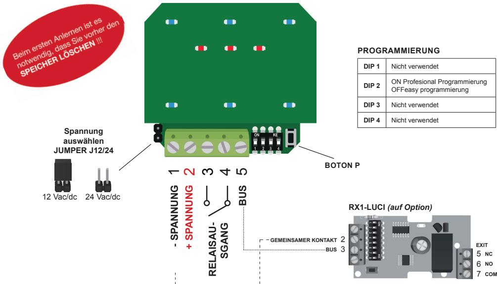
**PROGRAMMIERUNG UND SPANNUNG (1 und 2).** Der Empfänger kann mit 12 bis 24 V ac/ dc versorgt werden. Bei Gleichstrom beachten Sie die Polarität (positiver Pol soll auf der Klemmleiste 2 versorgt werden).
