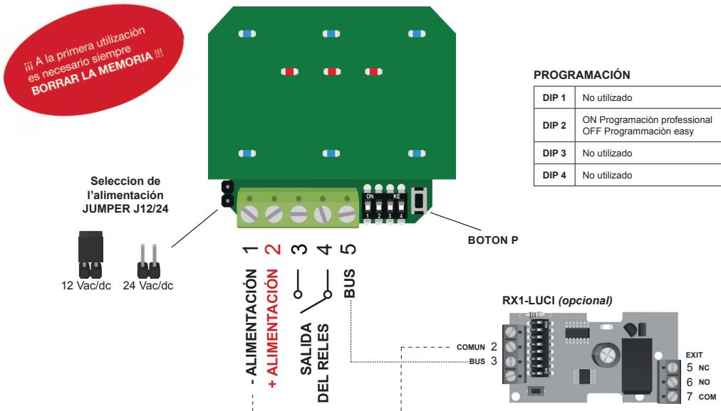
**ALIMENTACION (1 y 2).** El receptor puede ser alimentado 12/24 Vac/dc. Si se usa corriente continua se debe respetar la polaridad (positivo terminal n°2)
