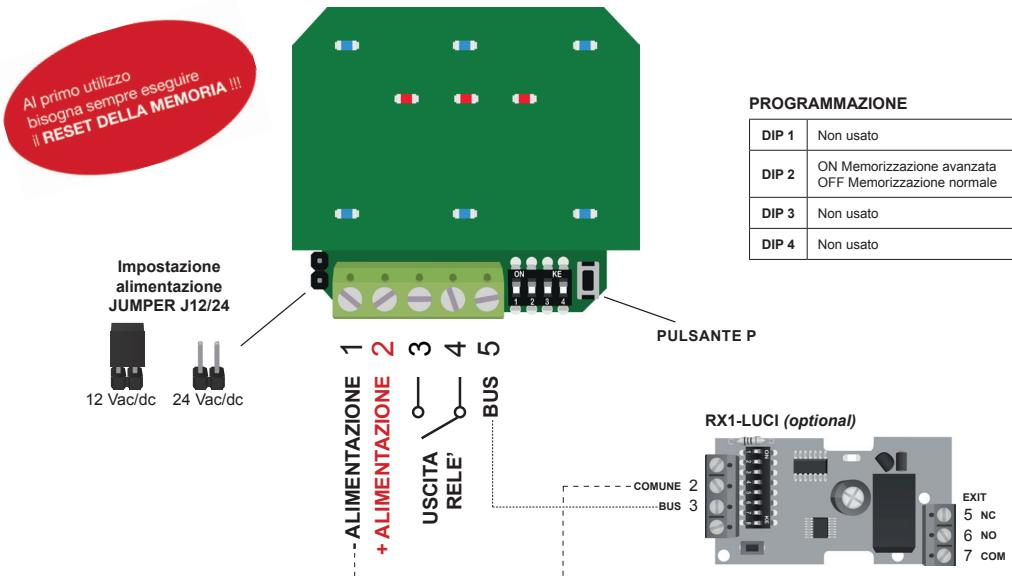
**ALIMENTAZIONE (1 e 2).** Il ricevitore può essere alimentato da 12 a 24 volt sia in corrente continua che in corrente alternata. Se si utilizza la corrente continua deve essere rispettata la polarità (il positivo sul morsetto n° 2).
