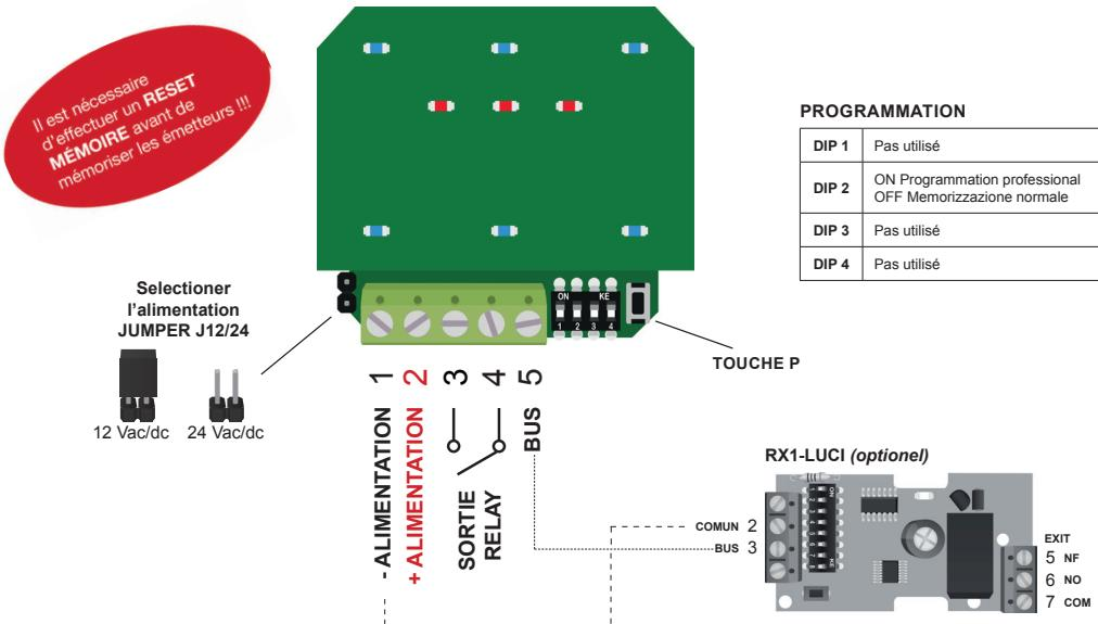
**ALIMENTATION (1 et 2).** Le récepteur peut être alimenté à 12/24Vac/dc. Si on utilise courant continu il faut respecter la polarité (le pôle positif branché sur le borne n°2)
