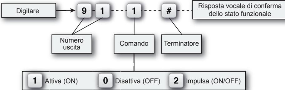
Comando DTMF Per bloccare un ciclo telefonico di allarme. Ascoltare il messaggio di allarme e attendere il Beep quindi tramite la tastiera del telefono inviare il comando di blocco.
