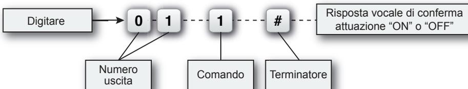
Comando dell'uscita 1, il combinatore verifica l'attuazione del comando e risponde dichiarando il suo stato.
