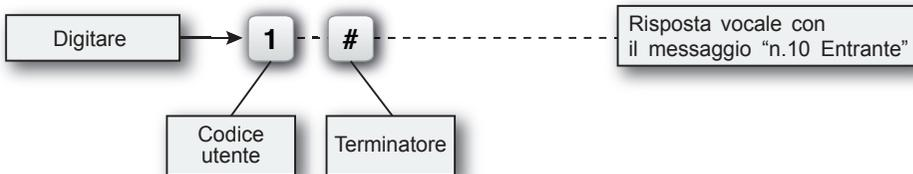
Comando dell'Uscite 1 e 2: per disattivarla il comando è "0", per attivarla il comando è "1", per far muovere l'uscita in modo impulsivo il comando è "2".
