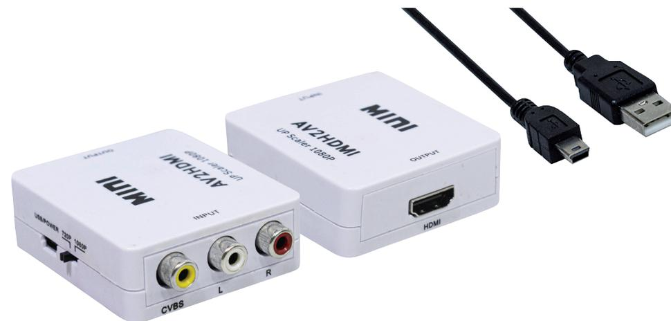
Con questo dispositivo è possibile convertire un segnale A/V analogico in un segnale HDMI con risoluzione massima 1080P (60Hz), permettendo così la visualizzazione del segnale A/V su un monitor HDTV.
