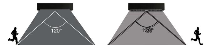
Se la batteria è carica al 30%, durante le ore notturne si accende solo su rilevazione di movimento, per poi spegnersi dopo 20 secondi dall'ultimo rilevamento.
