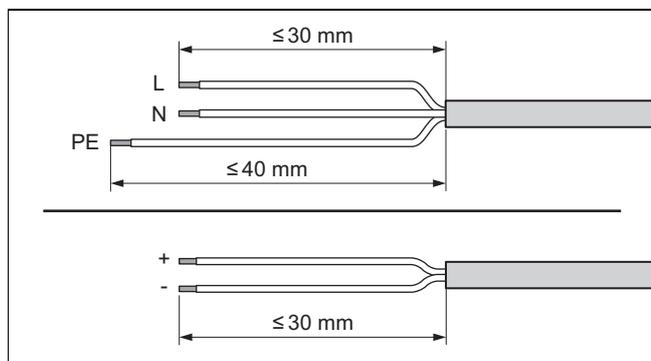
6. Rimuovere il rivestimento dai cavi flessibili come illustrato in figura. Evitare di danneggiare l'isolamento termico dei singoli cavi.
