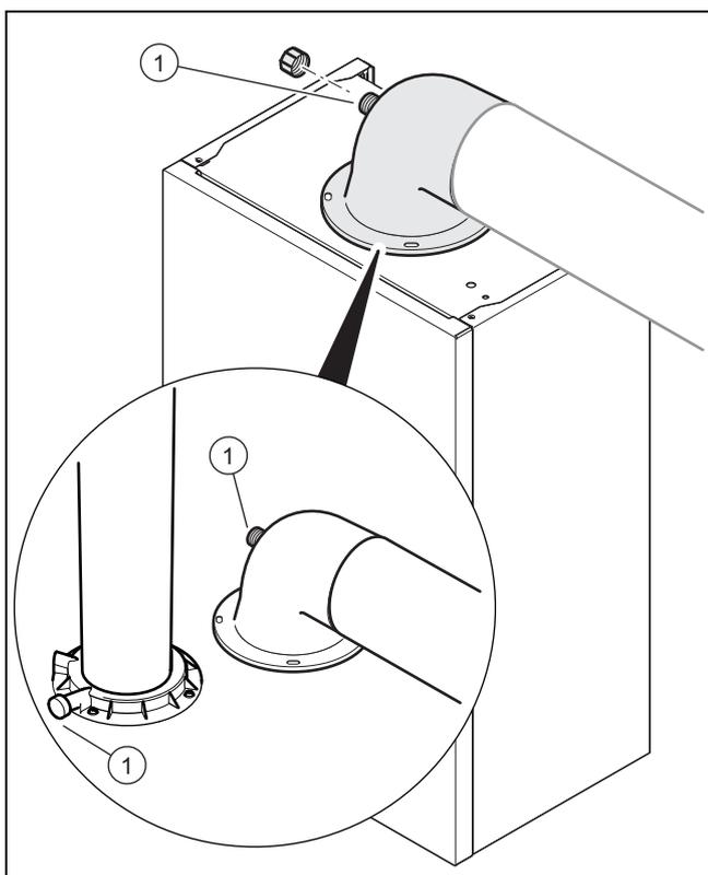
1. Aprire l'apertura di misurazione sul raccordo fumi (1).
