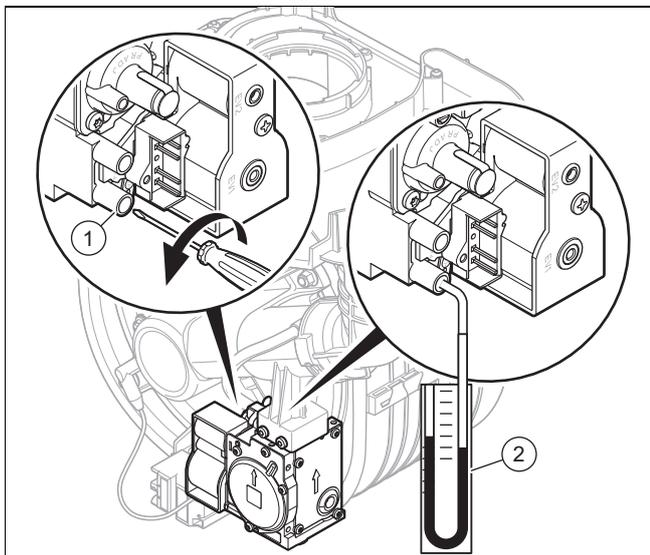
3. Ruotare la vite di controllo posta sul punto di presa della pressione del gas (1) in senso antiorario.
