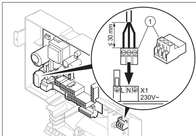
5. Innestare il connettore in dotazione (1) nella presa per 230V sulla scheda elettronica.
