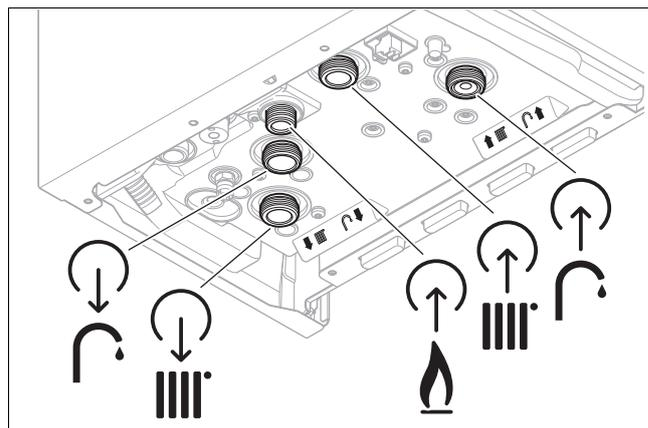
1. Installare la tubazione del gas sul raccordo del gas senza tensioni meccaniche.
