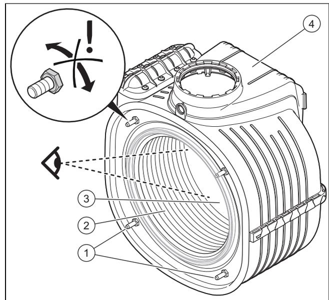
1. Pulire la serpentina (2) dello scambiatore di calore (4) con acqua o se necessario con aceto (acidità max. 5%).
