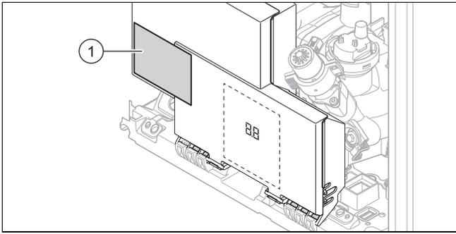
7. Contrassegnare il tipo di gas utilizzato sull'adesivo di trasformazione del gas.
