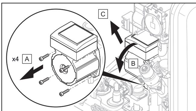
1. Smontare il motore della pompa come illustrato in figura.
