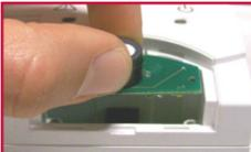
3 • Estrarre e sostituire il **Modulo sensore** (Fig.9). Verificare che il **Modulo sensore nuovo** sia compatibile con quello da sostituire (in caso di modulo sensore errato si accenderà il **LED GIALLO** e suonerà il BUZZER). Durante la sostituzione prestare attenzione ad inserire i 4 connettori nella sede appropriata.
