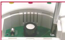
2 • Svitare le due viti di fissaggio del **Modulo sensore** da sostituire (Fig.7).
