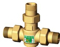
La valvola anticondensa **Art.3966** regola la temperatura dell'acqua di ritorno dall'accumulatore al generatore di calore a combustibile solido, prevenendo la comparsa di condensa nel circuito.
