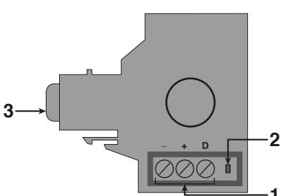
**1 Bornes de raccordement de l'installation :**
