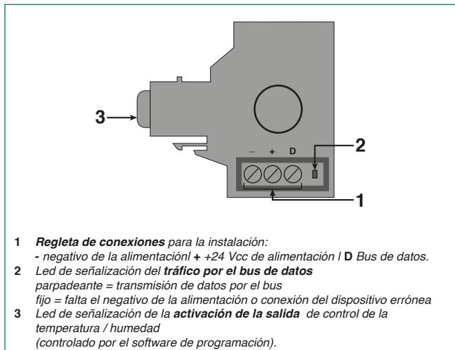
**FUNCIONAMIENTO DE LA SONDA**
