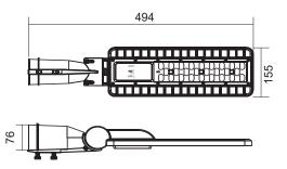
Tipologia: Armatura Stradale LED: SMD ad alta efficienza Corpo: Pressofuso di alluminio Alimentazione:
